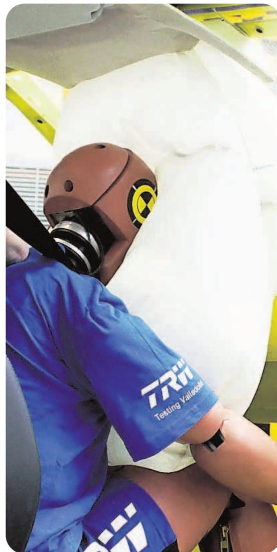
**Prueba de un airbag de choque frontal de pasajero en el techo.**
