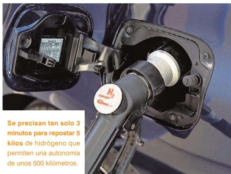
Se precisan tan solo 3 minutos para repostar 5 kilos de hidrógeno que permiten una autonomía de unos 500 kilómetros.
